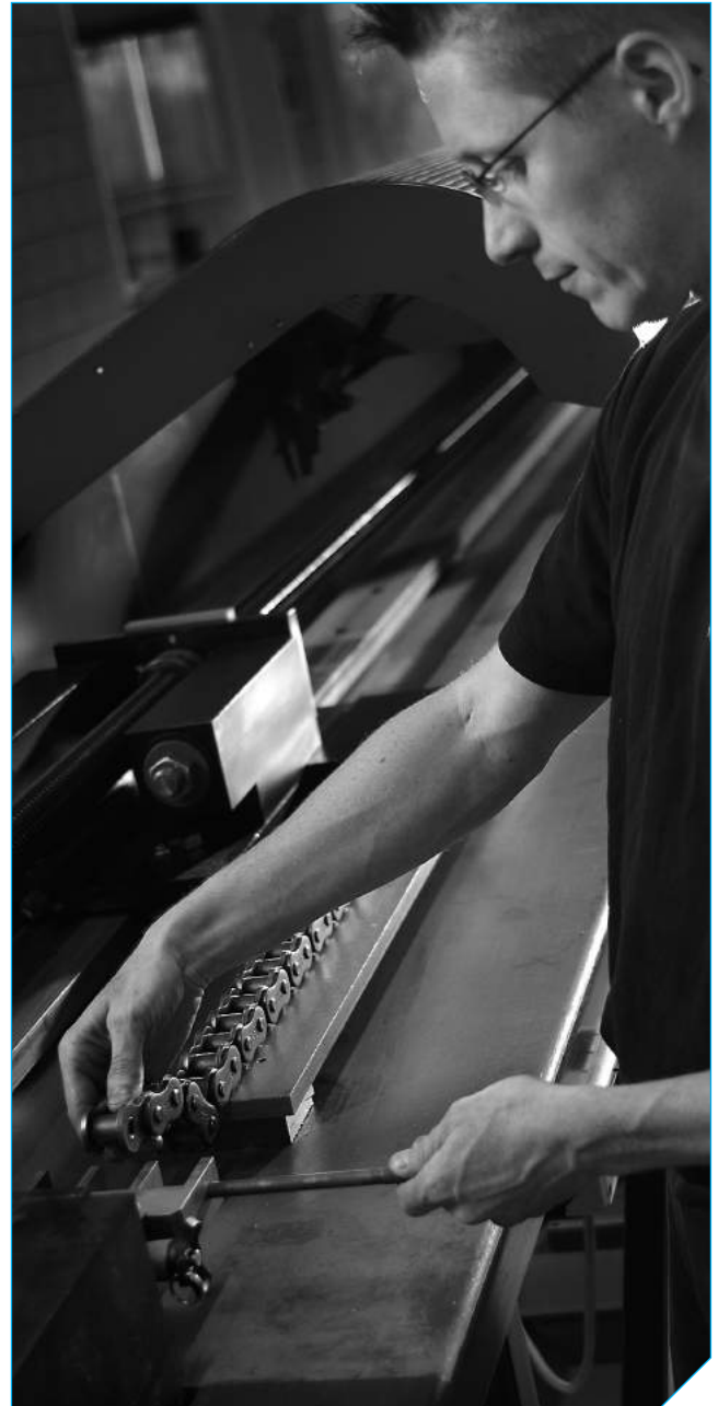
Abb. 20 Paarweises vorrecken für Parallellauf
